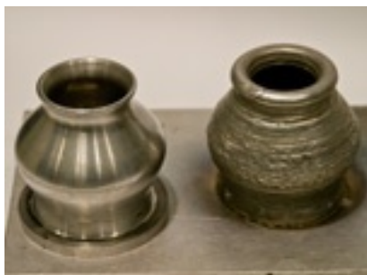
E-Beam Fabrication (EBF3) (ref K. Taminger LaRC)
